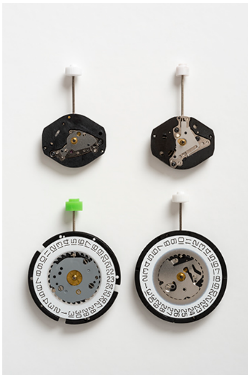
Vue d'ensemble des 4 mouvements : face côté cadran. De gauche à droite et de haut en bas : Isa 2326 et K 63, 317 et 2321.
