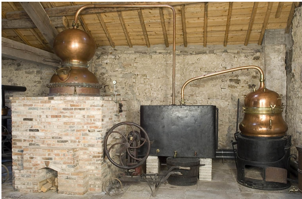
Alambics, chaudières et réfrigérant (au centre).
