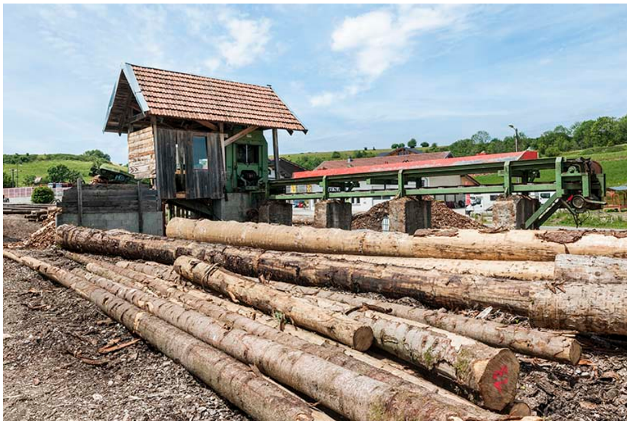
Parc à grumes et poste d'écorçage.
