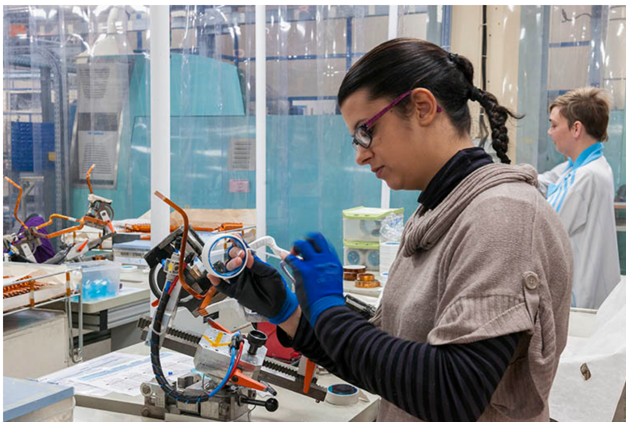
Isolation manuelle des barres de cuivre.
