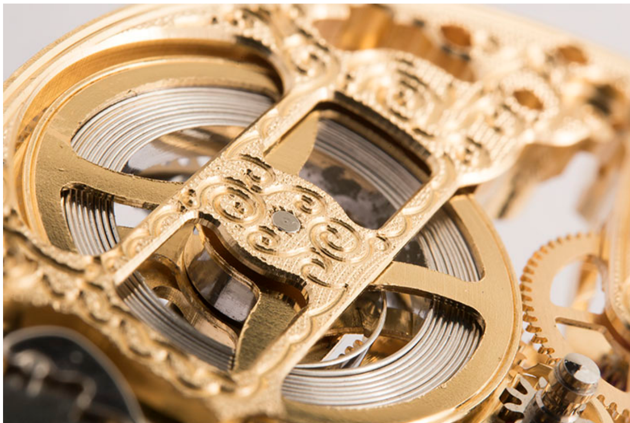
Détail : pont guilloché et ressort moteur.
