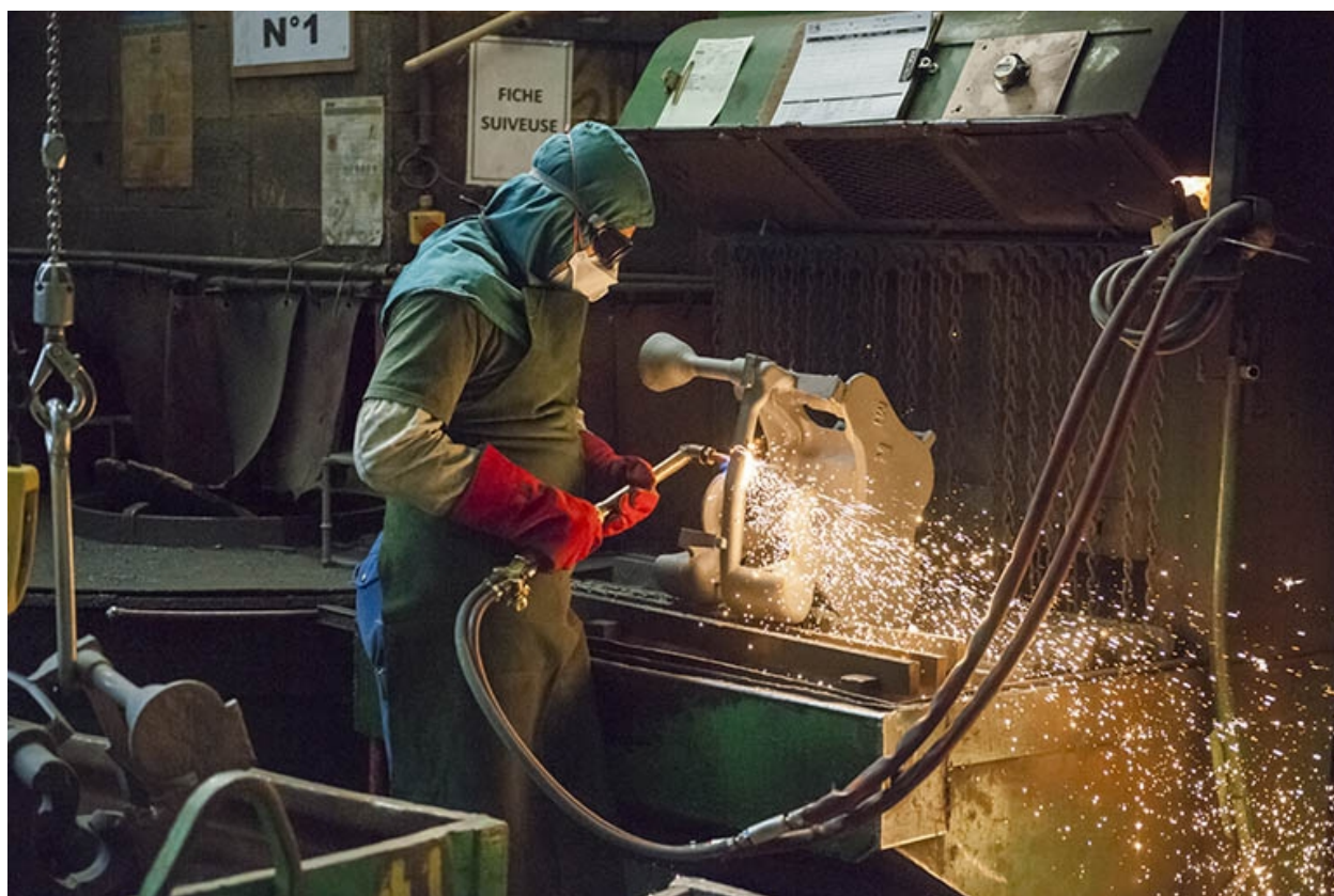
Découpage de pièces au chalumeau (2).
