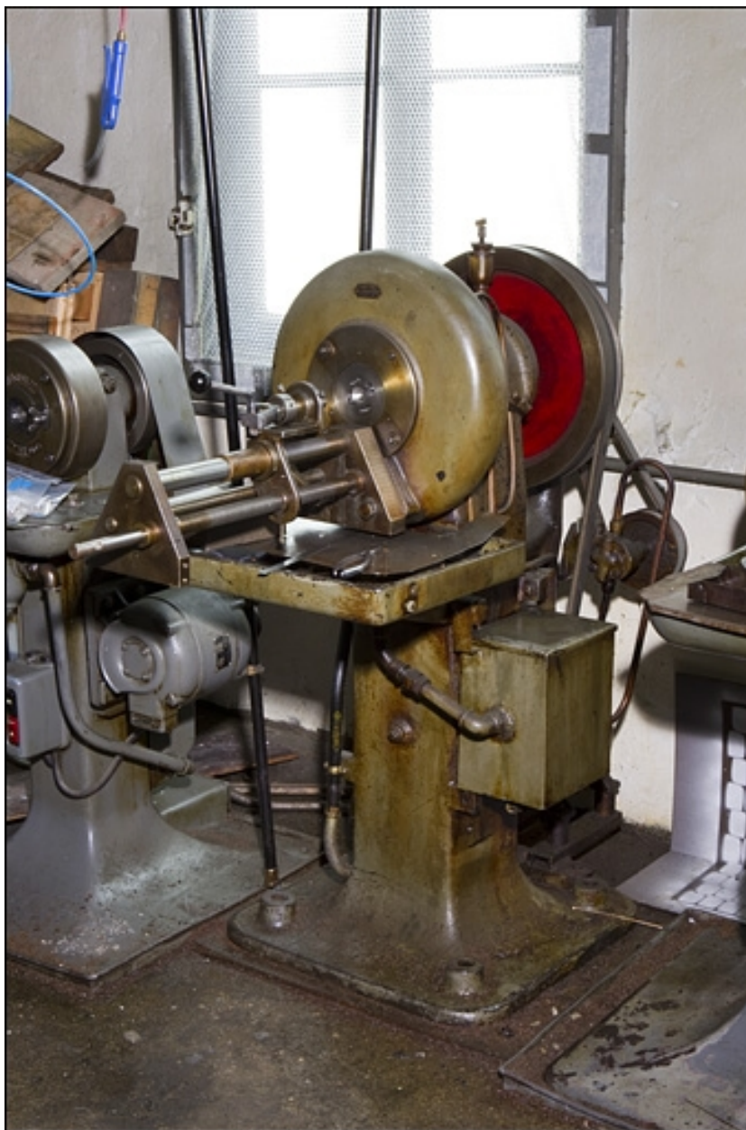
Usine Gouverneur-Audigier, Morez : machine à rétreindre Chanay et Maitrot.
