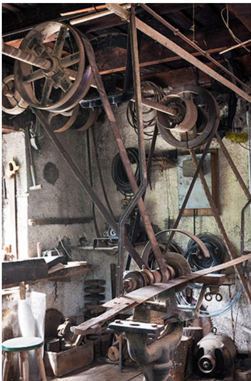
Affûteuse avec son mécanisme de transmission.
