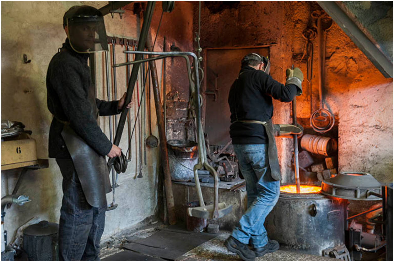
Préparation de la potence pour lever la poche de bronze en fusion (creuset).
