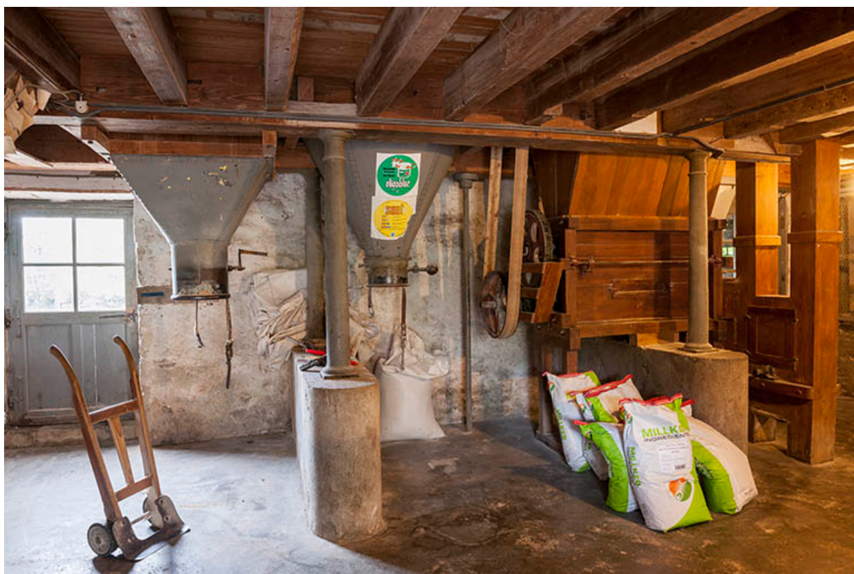
Rez-de-chaussée. Poste d'ensachage et mélangeuse.
