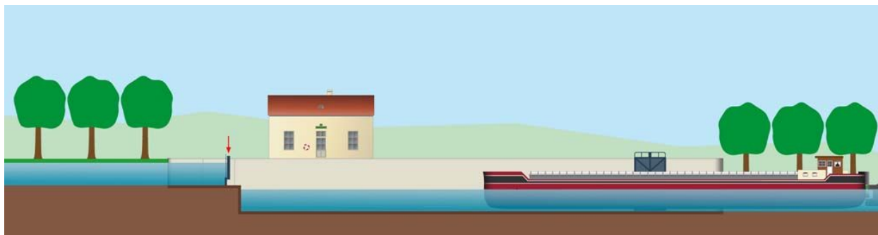
Schéma d'éclusage d'un bateau montant, étape 3.
