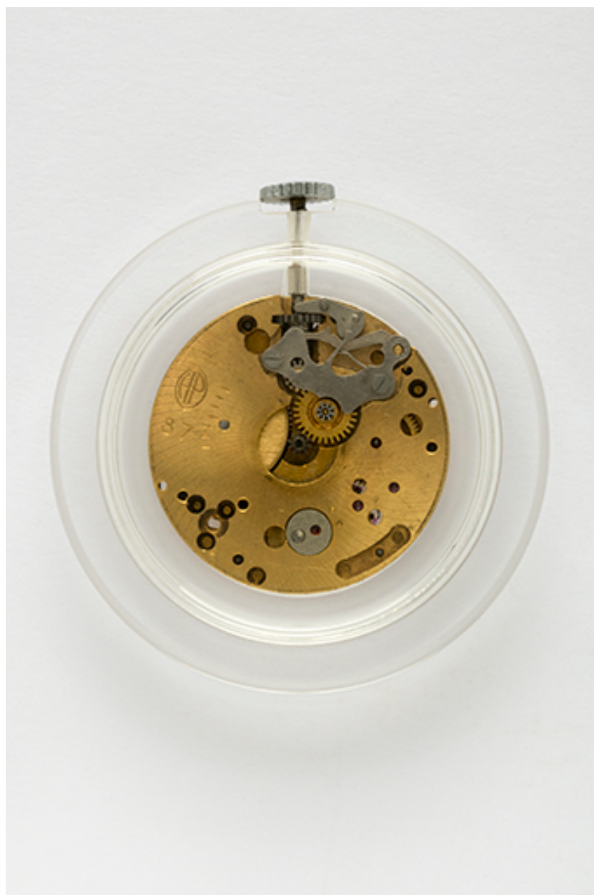
Mouvement Parrenin HP 87 : face côté cadran.
