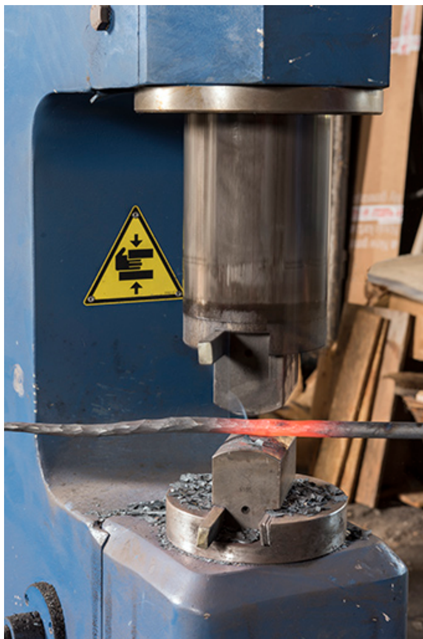
Martelage d'une barre au marteau-pilon pneumatique Glaser.
