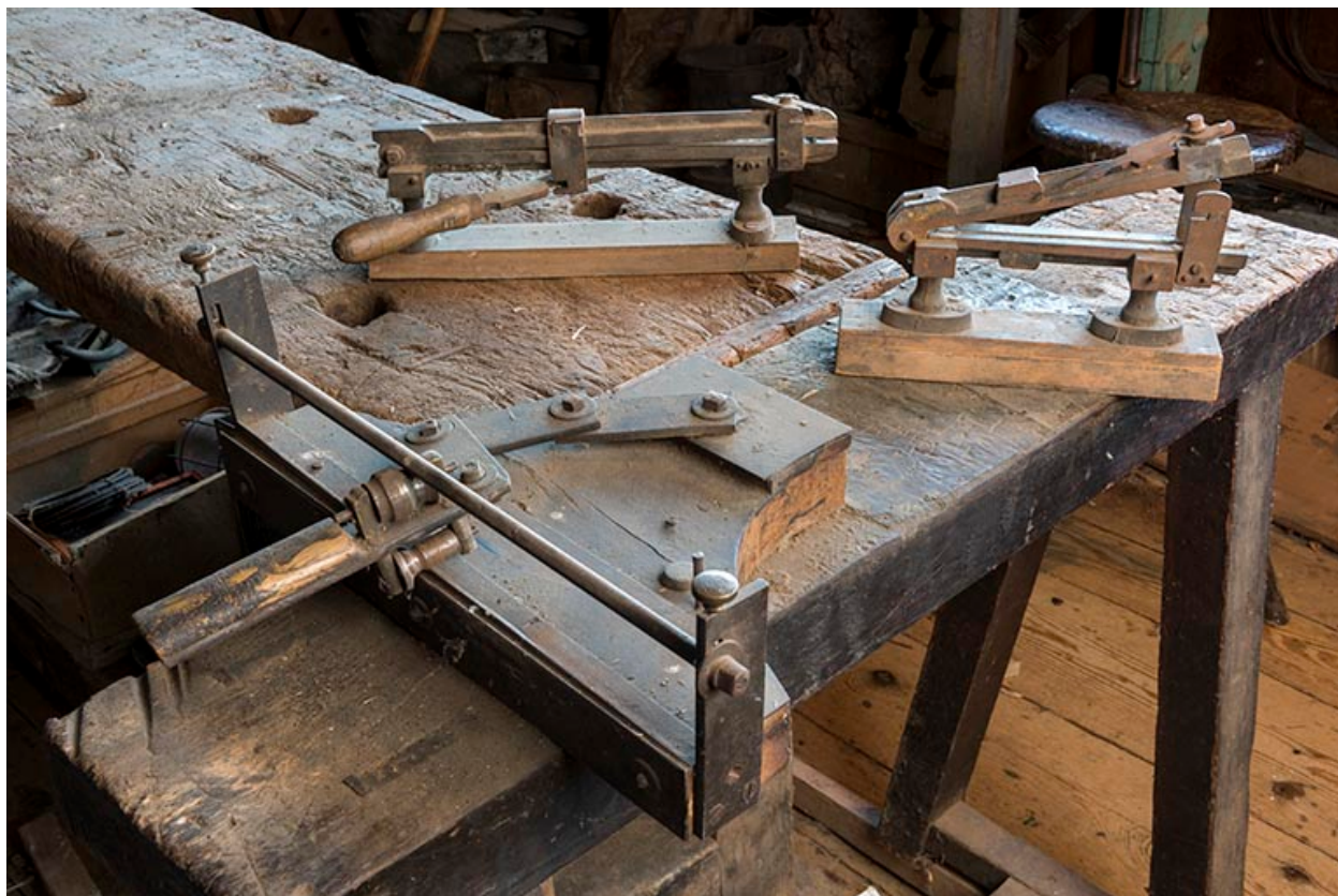
Atelier : machine à redresser les barres et autres machines.
