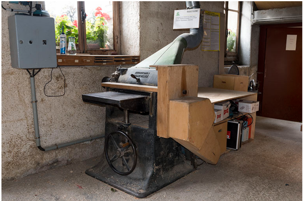
Atelier de fabrication : raboteuse Guilliet.
