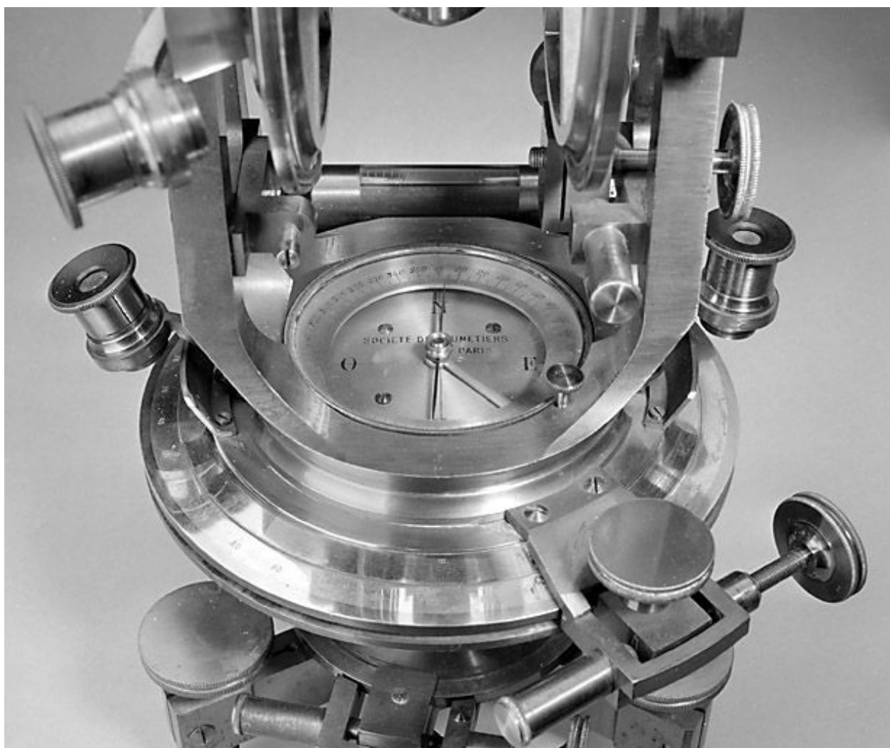
Le cercle azimutal et la boussole.
