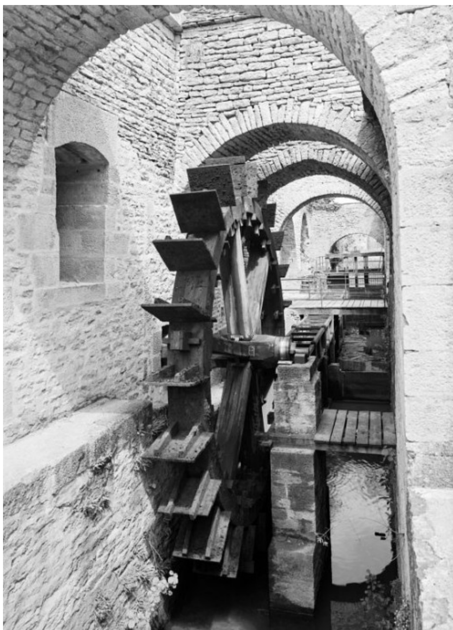
Haut fourneau, roue hydraulique reconstituée.
