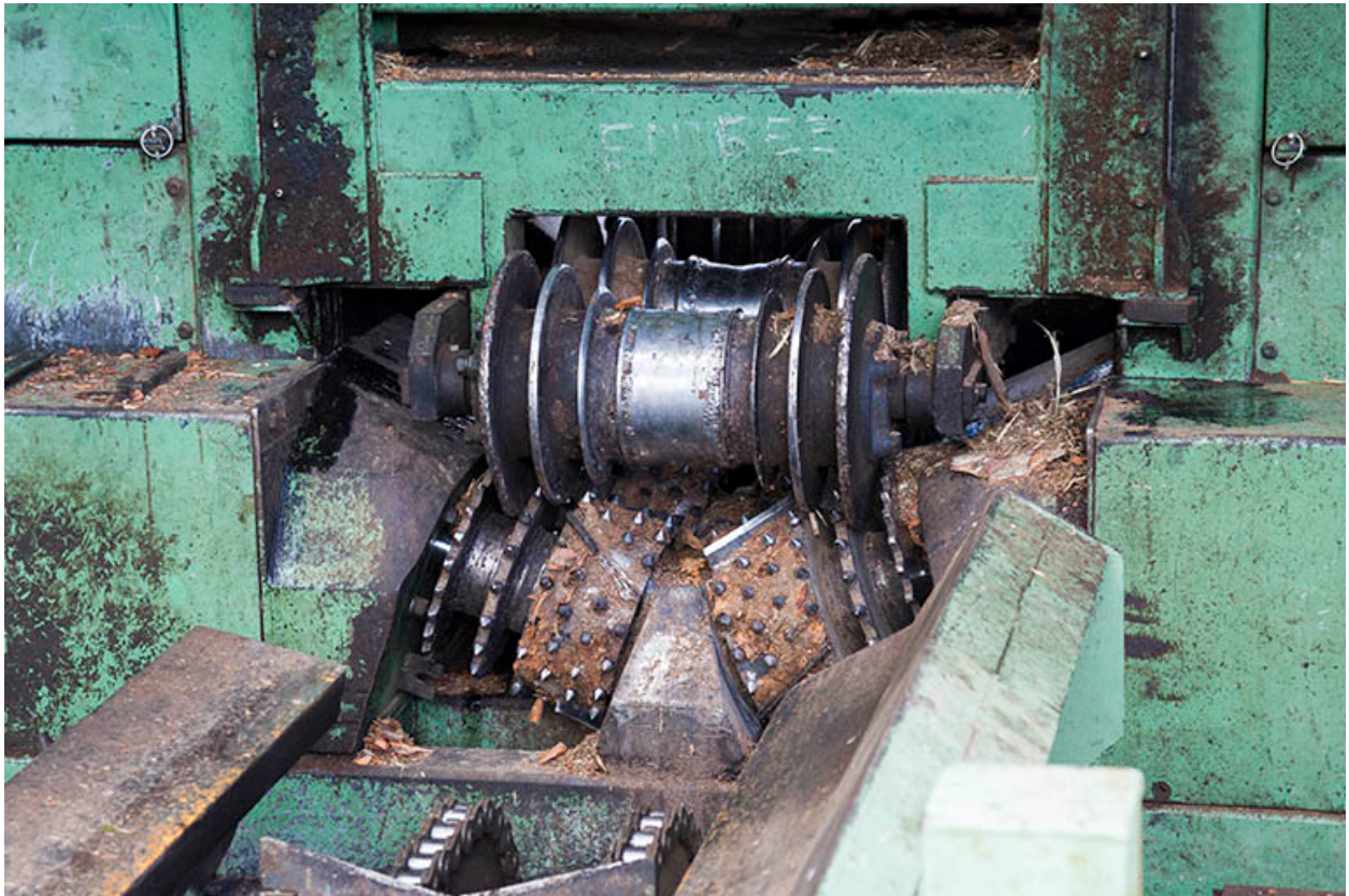
Installation de billonnage : détail des rouleaux.
