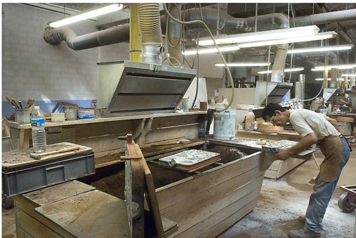
Poste de moulage. Préparation d'un moule.
