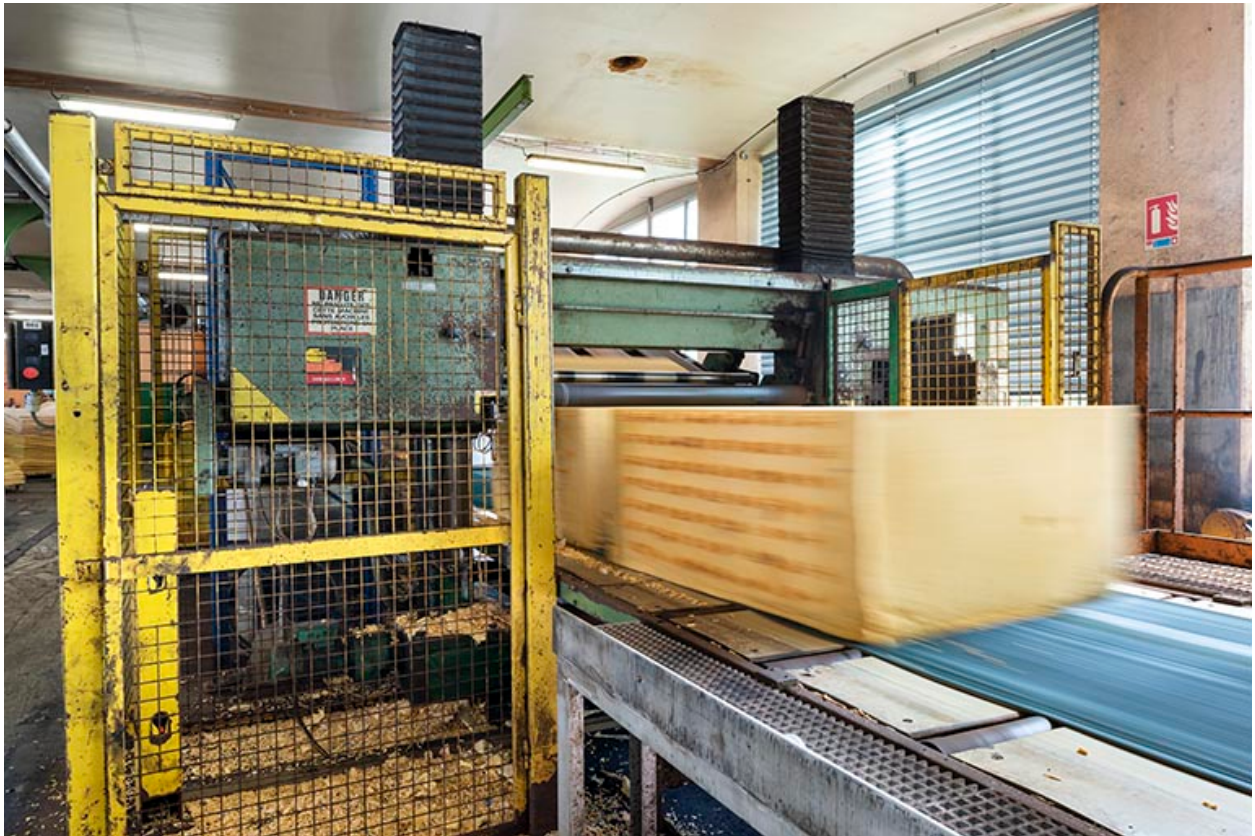
Fabrication : découpe d'un bloc en plaques.
