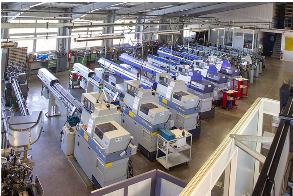
Machines à décolleter à commande numérique : usine de décolletage des Ets Perrenoud (rue Pierre Mendès-France).
