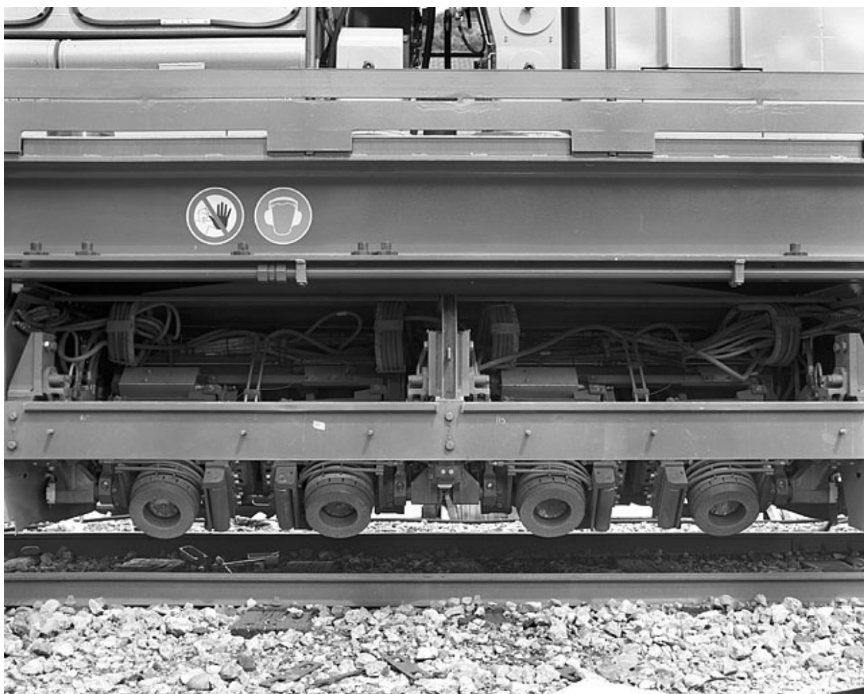
Train de meulage : système de meulage.
