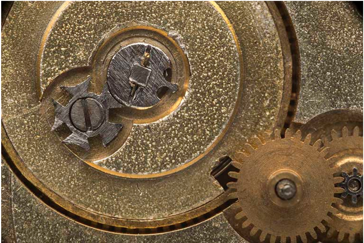
Montre de gousset de la fin du 18e siècle ou du début du 19e siècle : la croix de Malte (système d'arrêtage permettant de limiter le degré d'armage du barillet).
