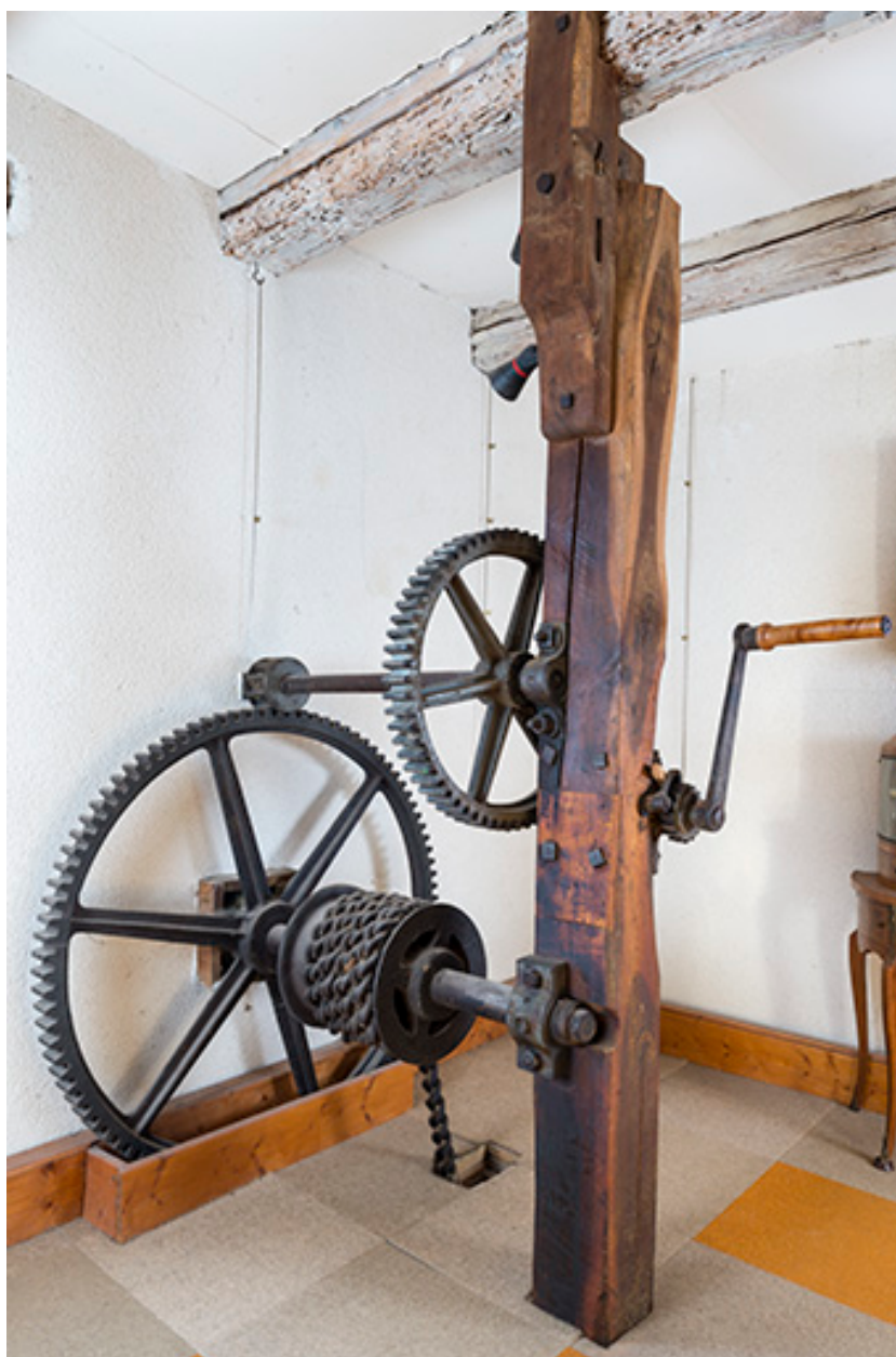
Premier étage. Système de levage (par manivelle et chaîne) de la roue suspendue (aval).
