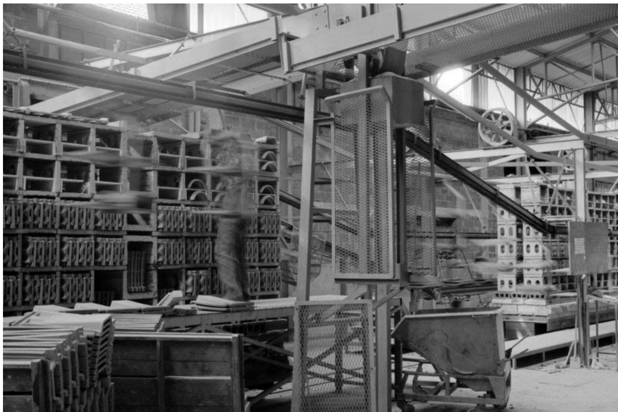
Atelier (K) : chargement de wagonnets.
