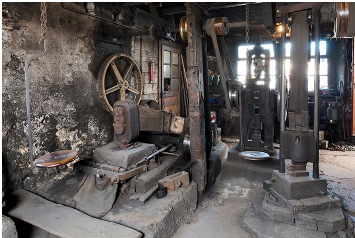
Ferme, atelier de taillanderie et de tournerie Vuillemin, Grand'Combe-Châteleu : martinets et mouton.
