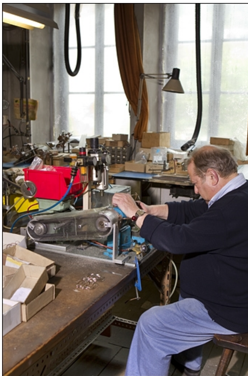
Sciage des tenons en deux.
