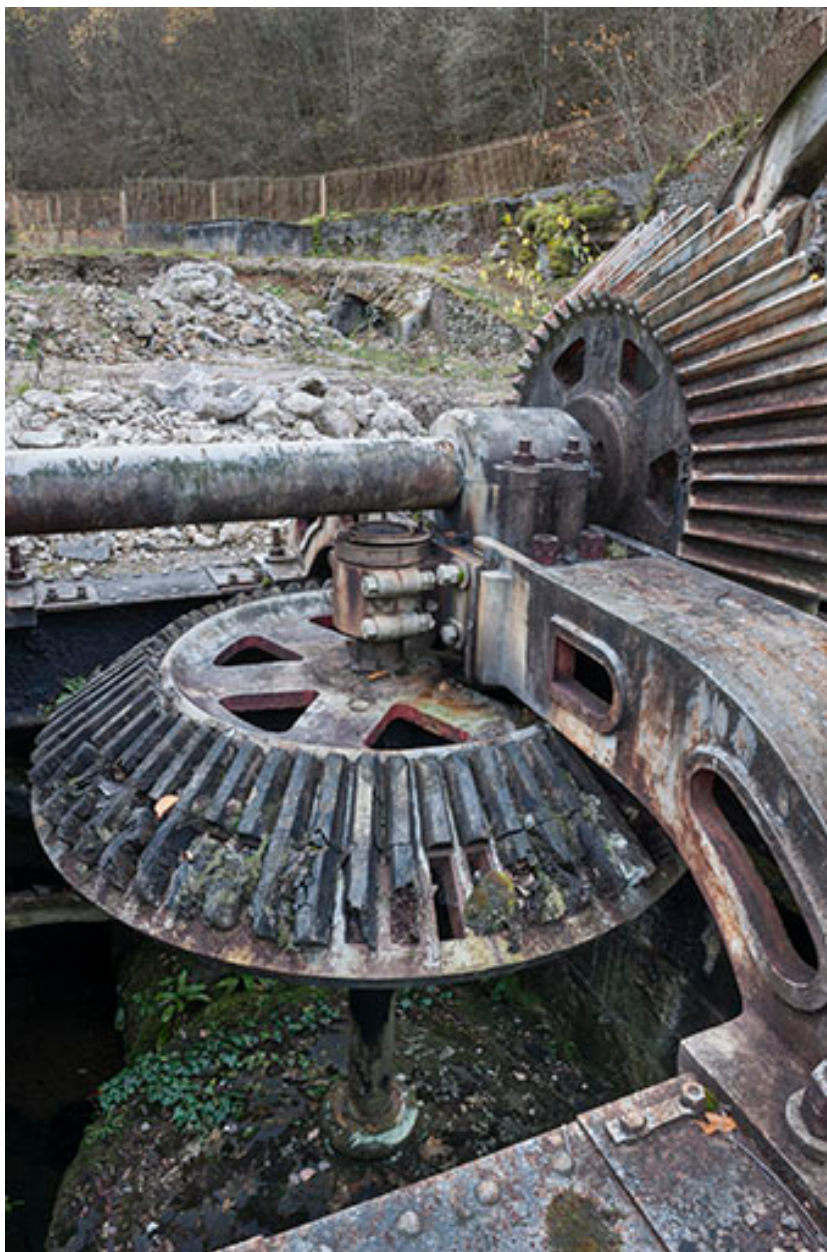
Turbine double. Détail des engrenages coniques.
