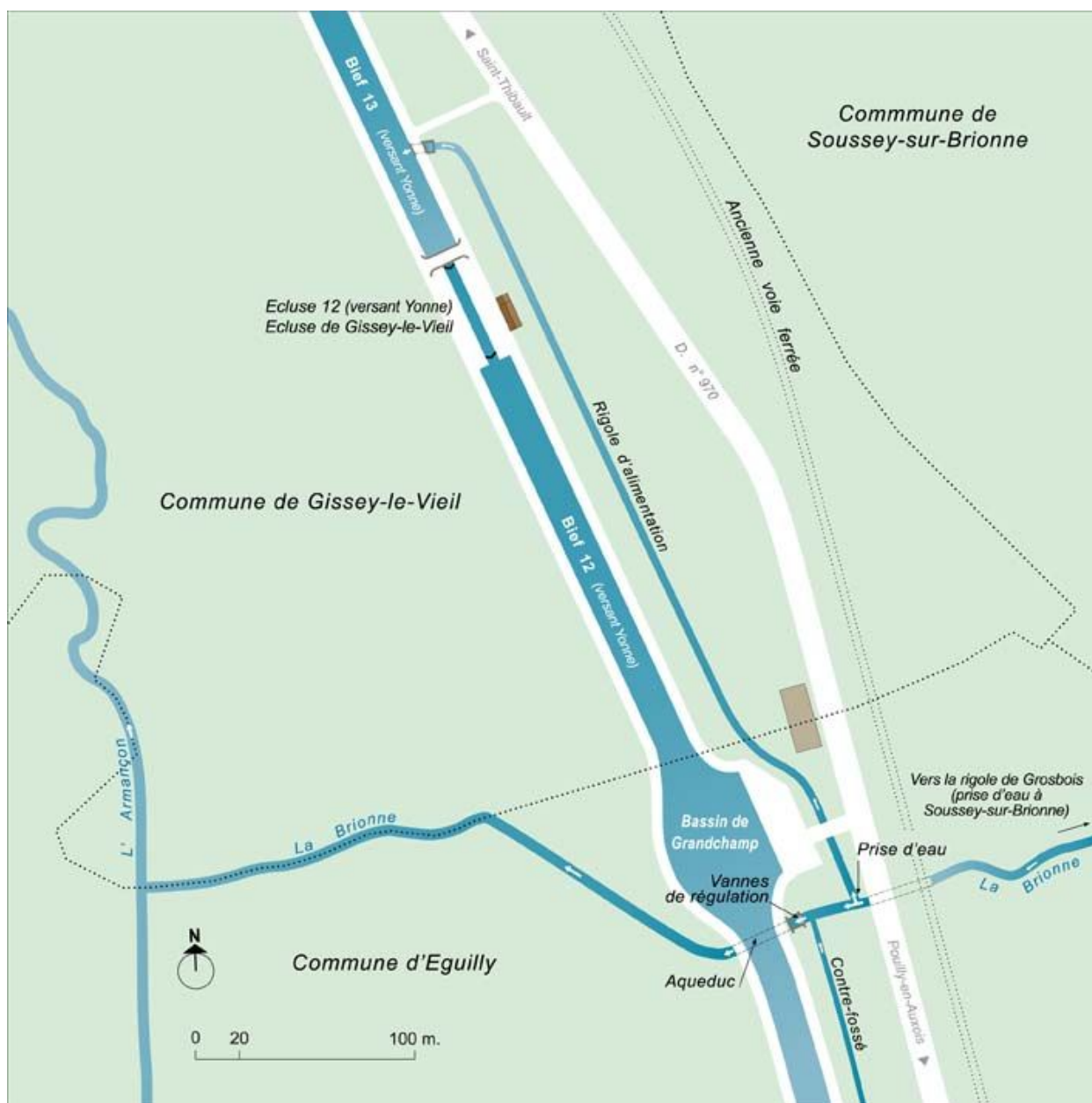
Plan schématique du réseau hydraulique aux biefs 12 et 13 du versant Yonne.
