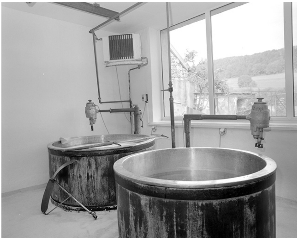
Chaudières, avec brasseur mécanique et tranche-caillé manuel.
