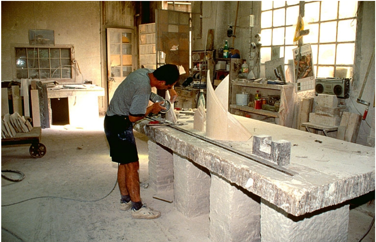
Polissage d'un limon d'escalier.
