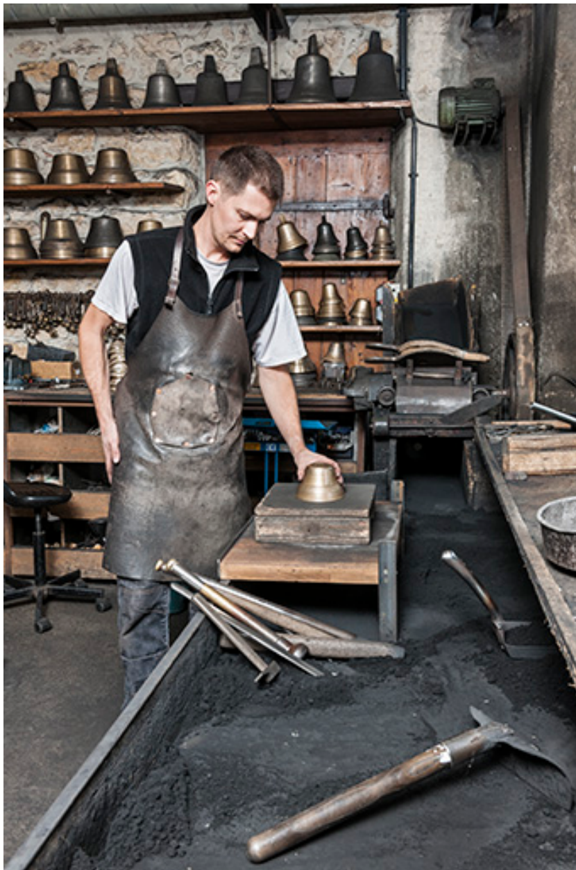
Moulage. Positionnement du modèle (donne l'empreinte extérieure).
