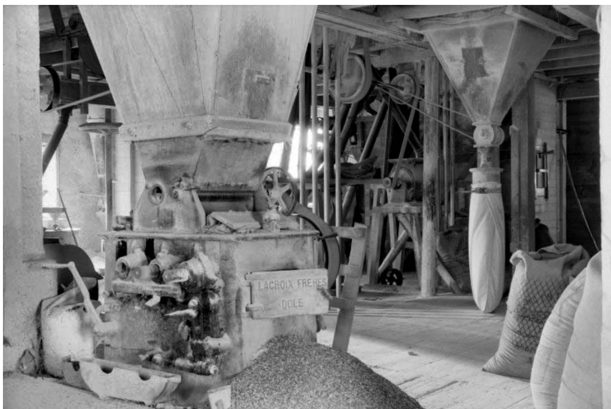
Appareil à cylindres Lacroix (minoterie Durand, Chemin).
