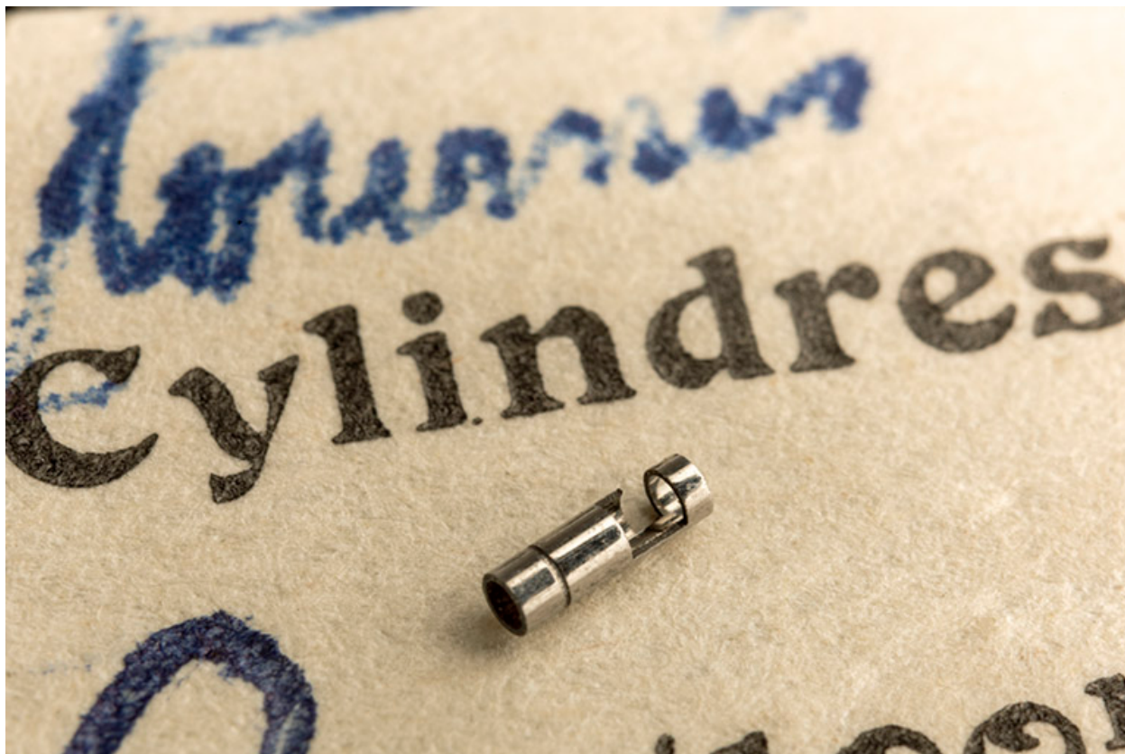
Ecorce de cylindre achevée et polie.
