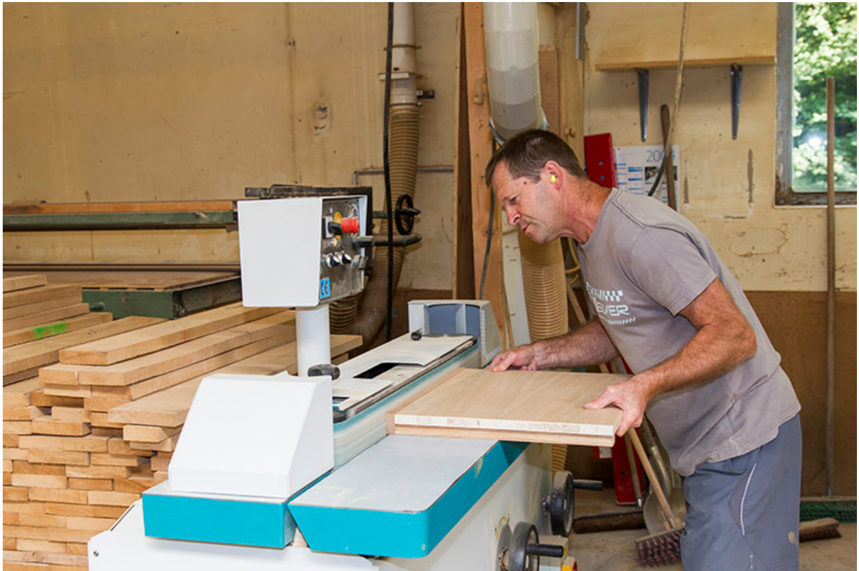
Atelier des années 1980 : ponceuse de chant Griggio.
