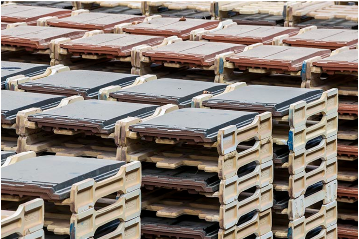
Tuilerie et briqueterie Migeon, à Lantenne-Vertière : unité de fabrication UL 2. Tuiles sur leurs supports réfractaires individuels (destinés au four piscine).
