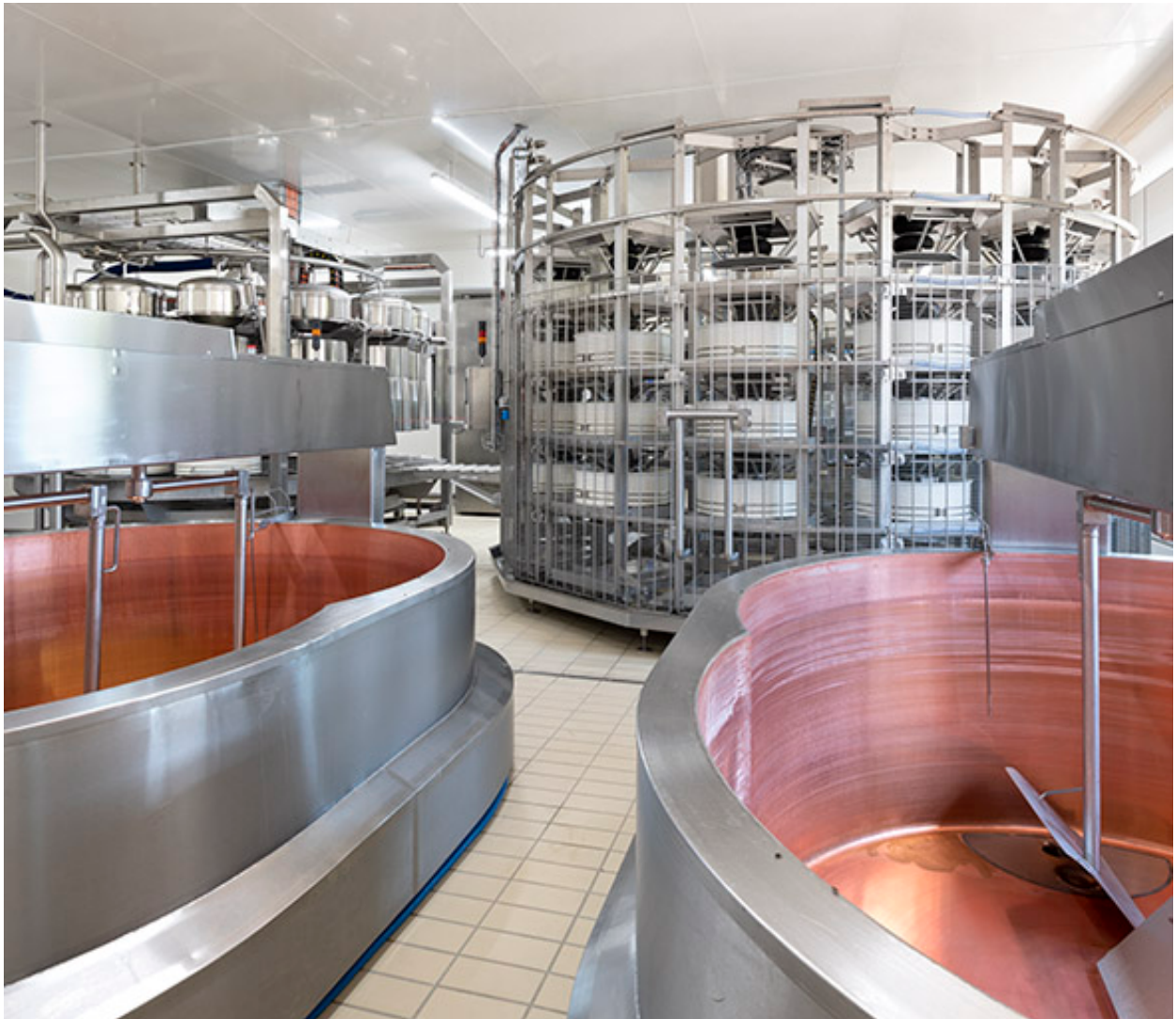
Installation de pressage, vue depuis les cuves.
