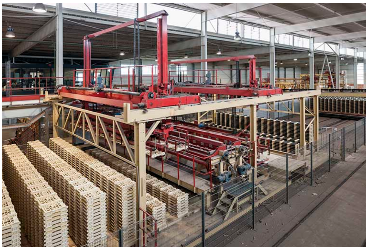
Unité de fabrication dite UL 5. Poste d'empilage-dépilage des tuiles sur supports réfractaires.
