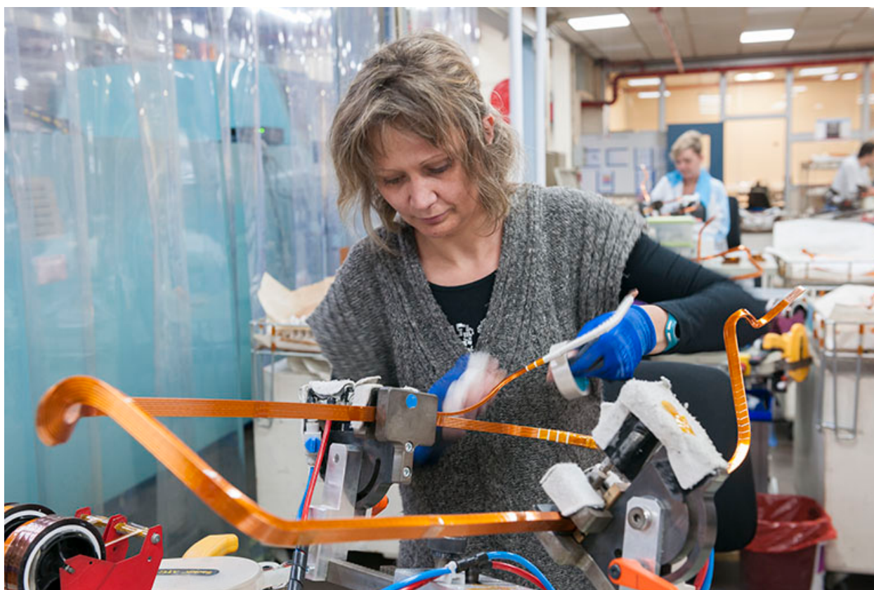
Isolation manuelle des barres de cuivre.
