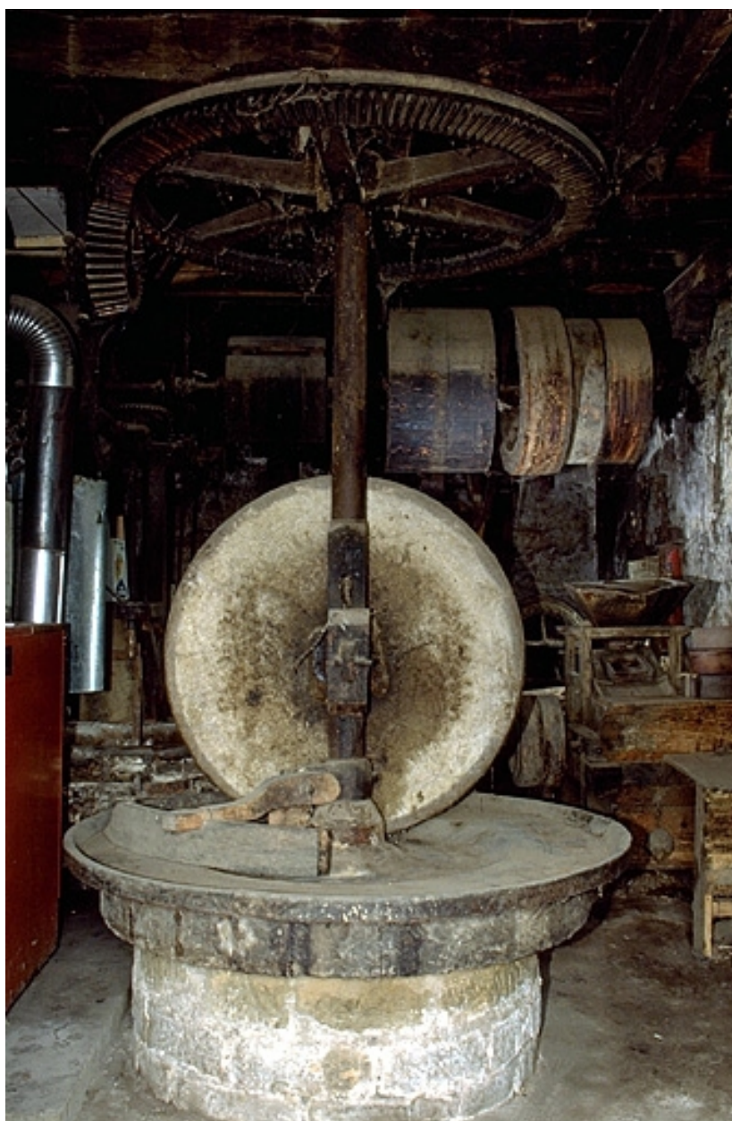
Atelier de fabrication. Au premier plan : meules et transmission.
