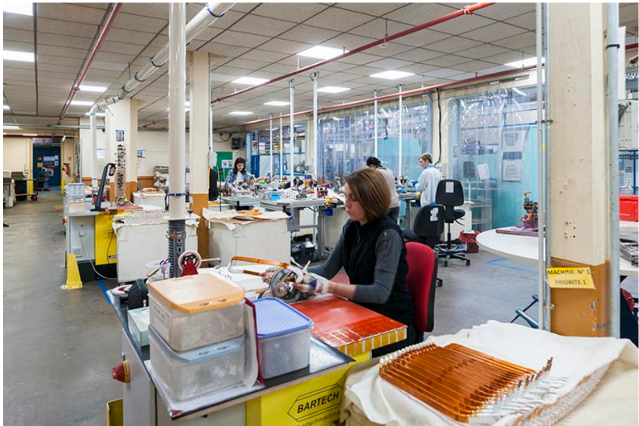
Isolation semi-automatique des barres de cuivre.
