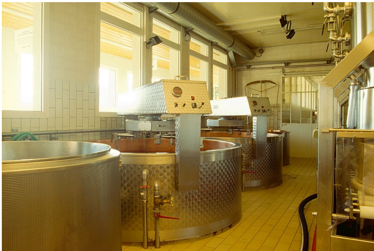
Cuves de fabrication du comté.
