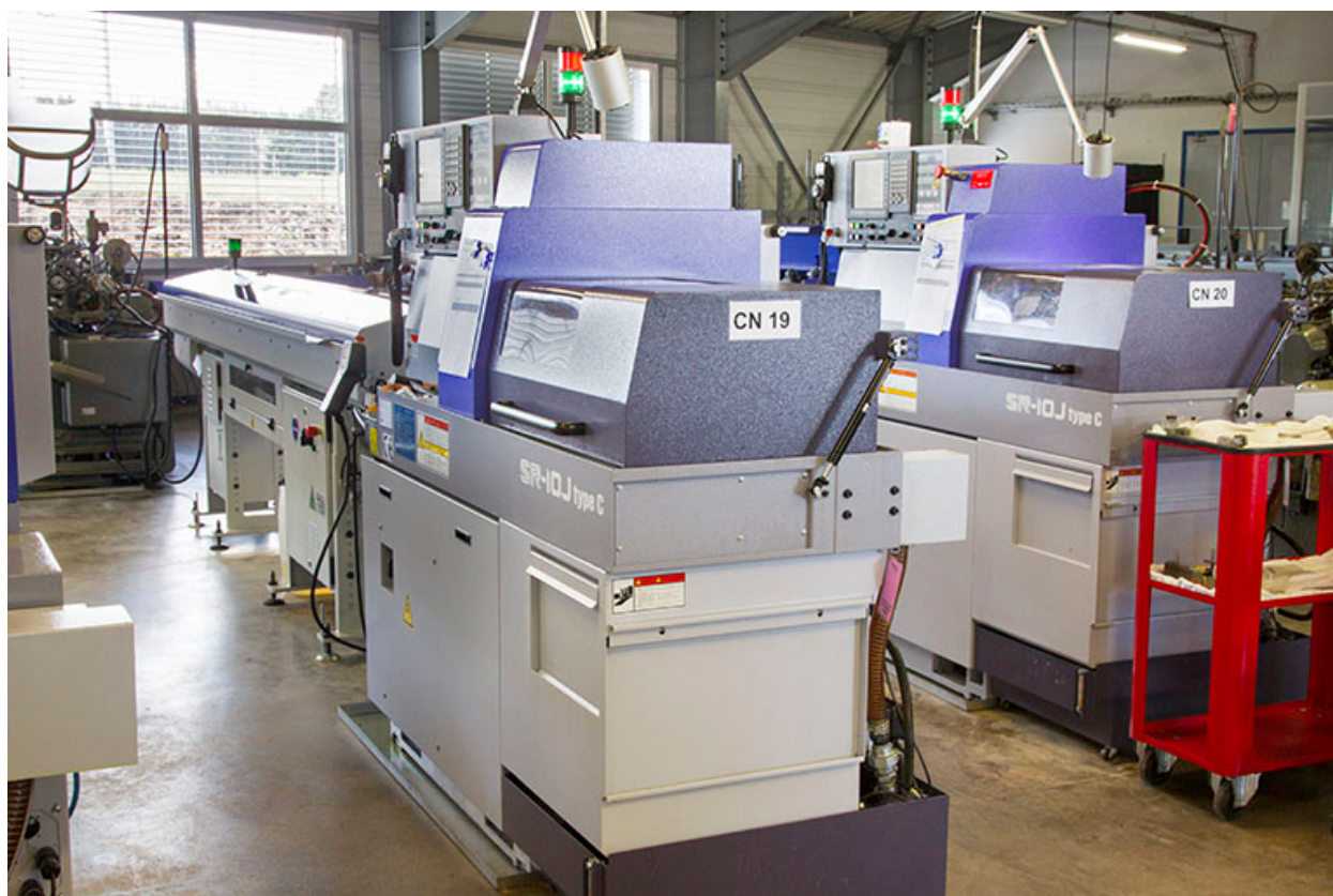
Machine à décolleter Star SR-10J type C.
