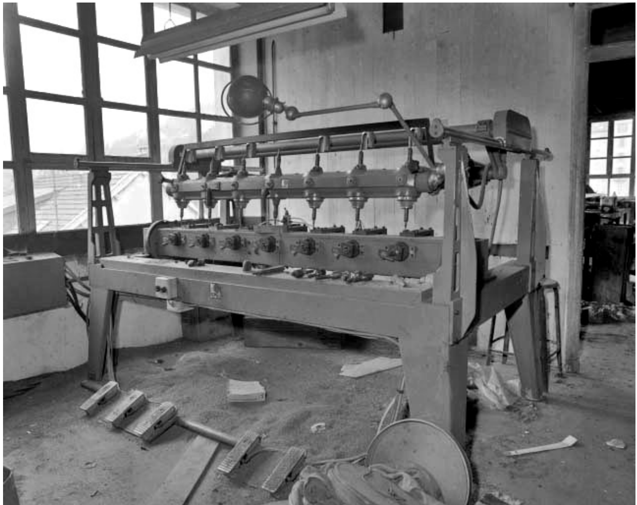
Machine à sculpter et à râper ACIMALL "la Scolpitrice".Pantographe avec palpeur central et 6 fraises.
