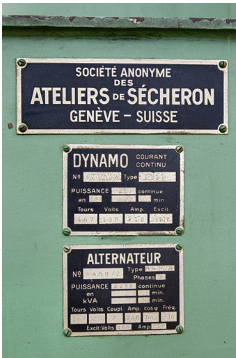
Plaque de constructeur de l'alternateur.
