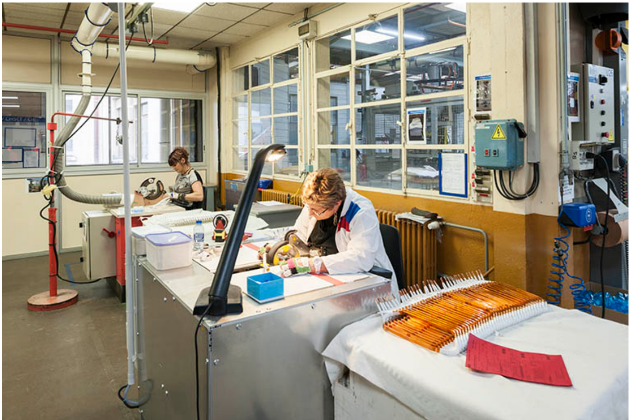
Isolation semi-automatique des barres de cuivre.
