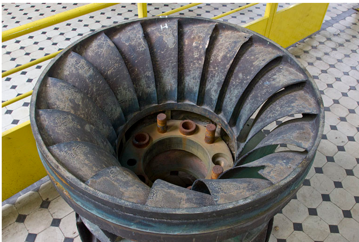
Extrémité des aubes de la roue d'une turbine Francis double.
