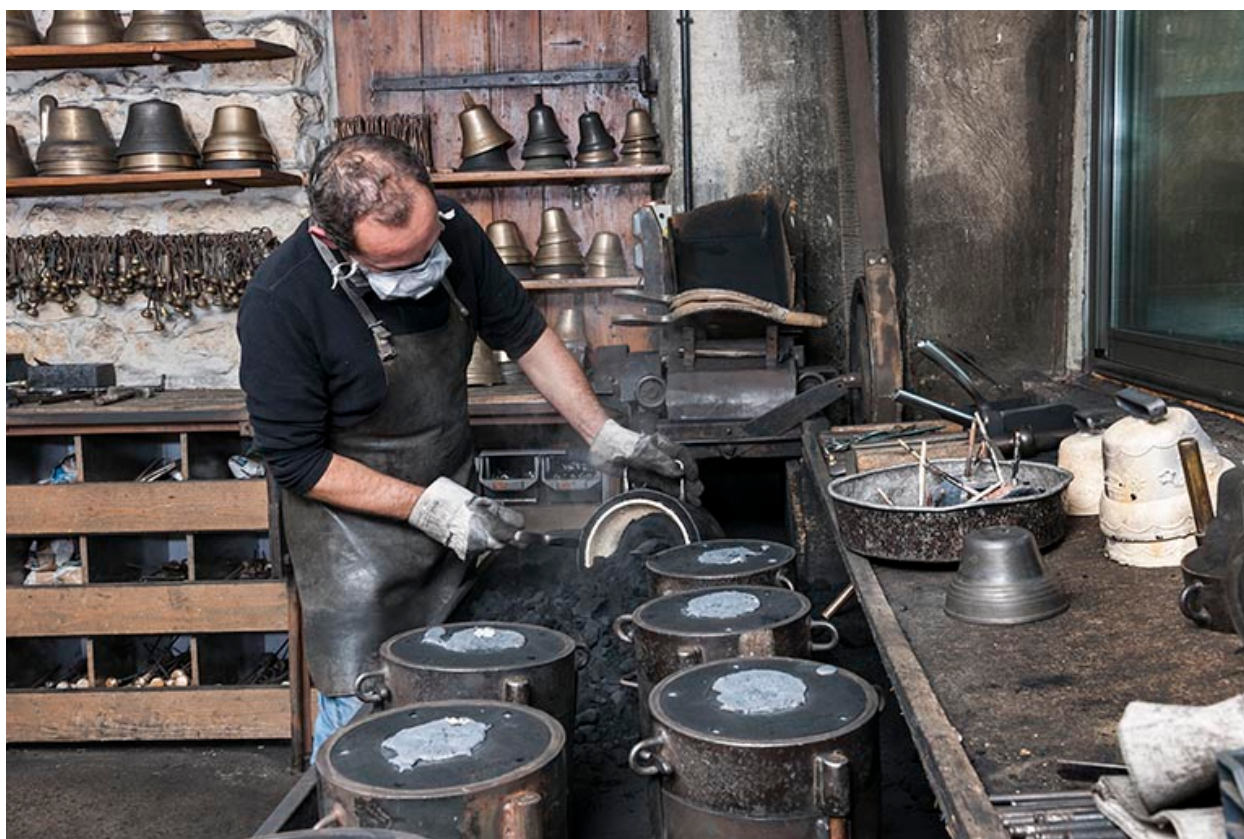
Démoulage. Extraction de la cloche (3).
