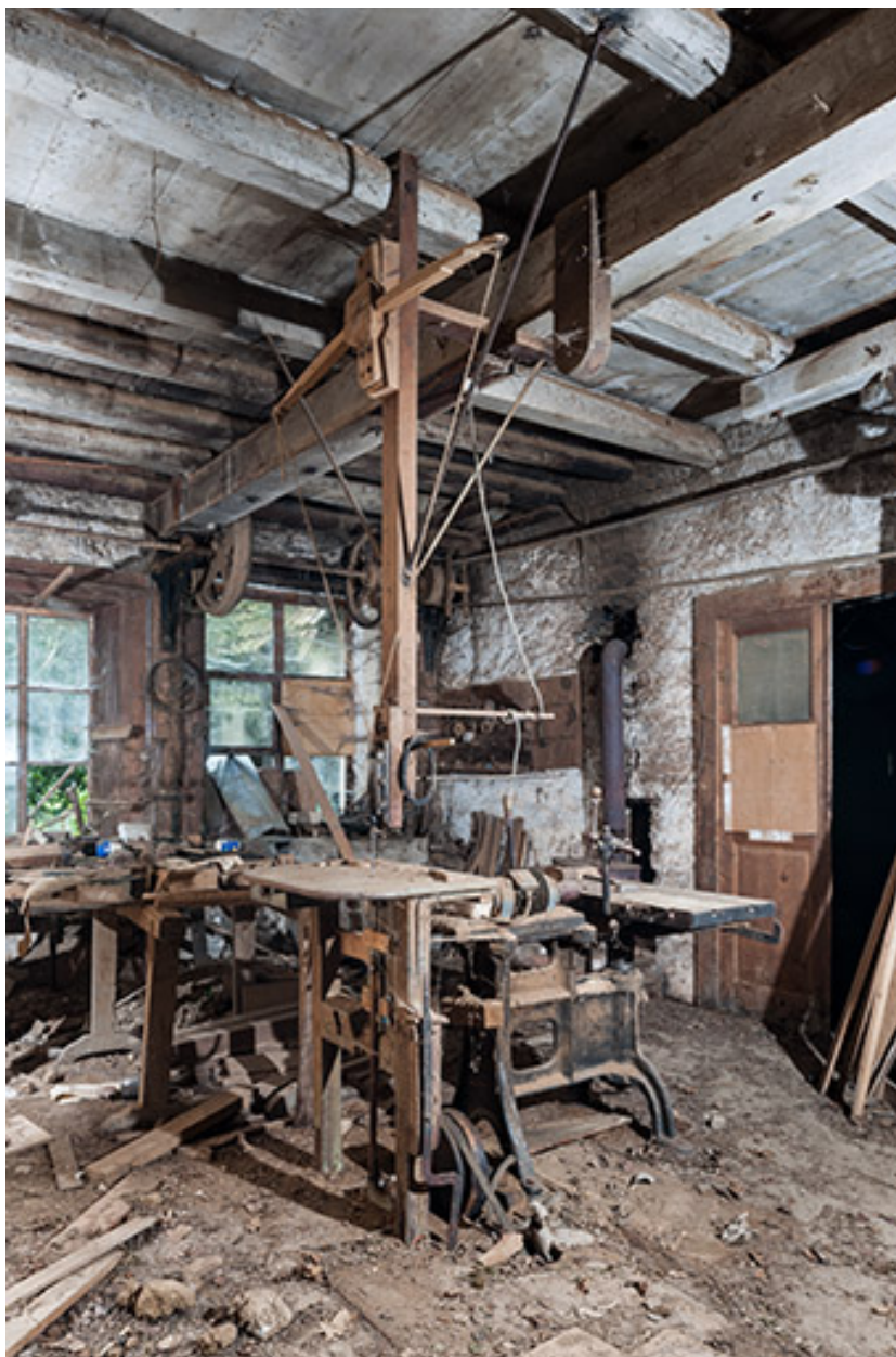
Atelier à l'étage de soubassement. Scie "arbalète" alternative et machine à mortaiser.
