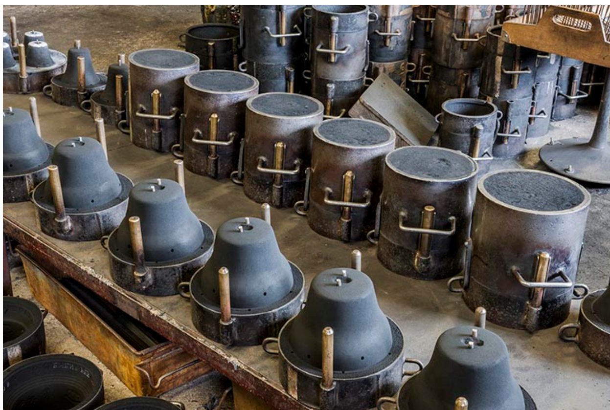
Châssis et moulages en attente.
